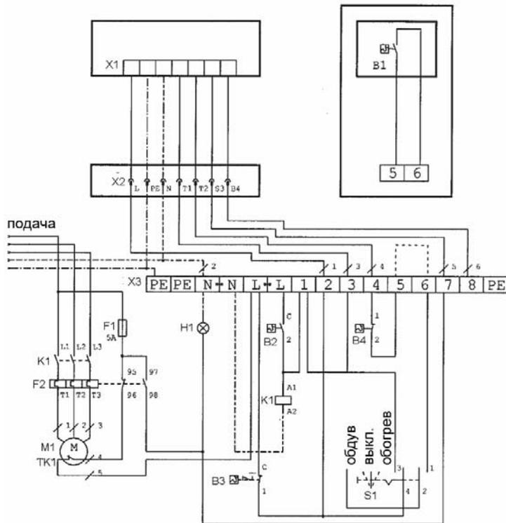
При подключении комнатного термостата удалить переключки между клеммами 5+6
