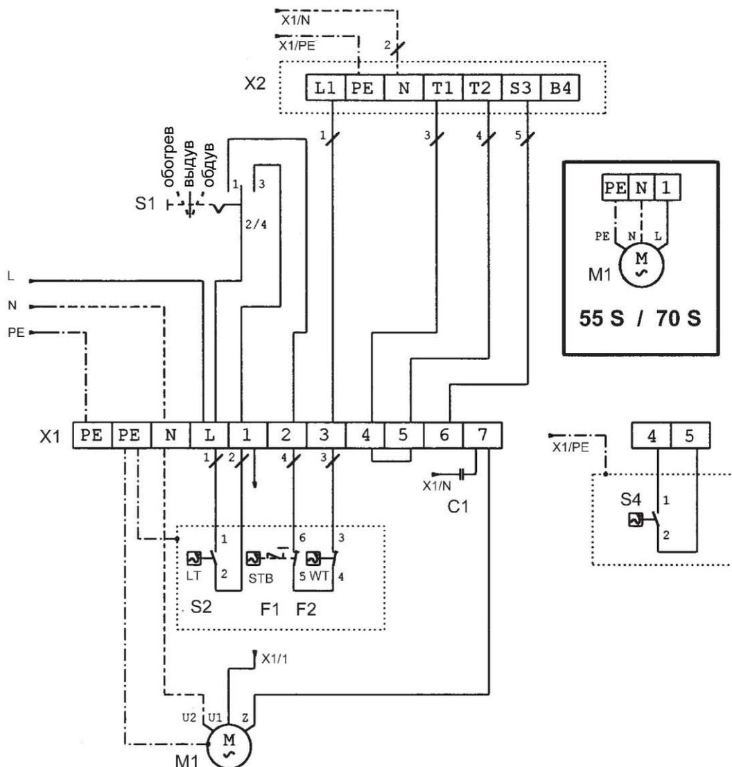
При подключении комнатного термостата удалить перемычки между клеммами 5+6
