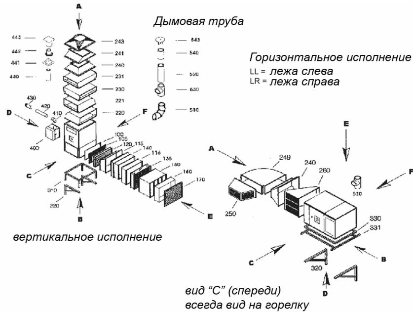
Тепловой генератор для канального устройства может быть снабжен встроенными частями или дополнен ими. Встроенные части изготовлены из оцинкованной стали.
