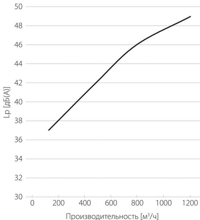
Уровень звукового давления для помещения со средним коэффициентом звукопоглощения, объёмом 500 м³, на расстоянии 5м от аппарата.
