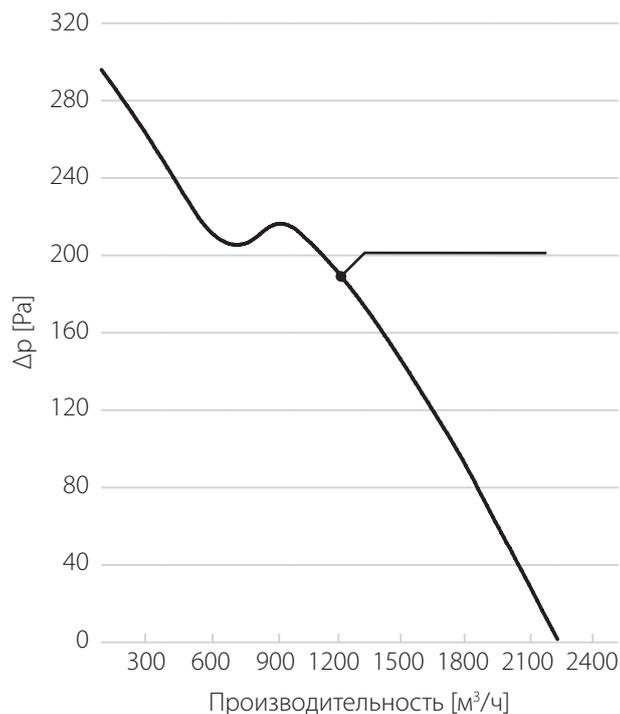
Максимальная производительность при работе оборудования с фильтром EU4 и установкой для забора/выброса воздуха OхS.
