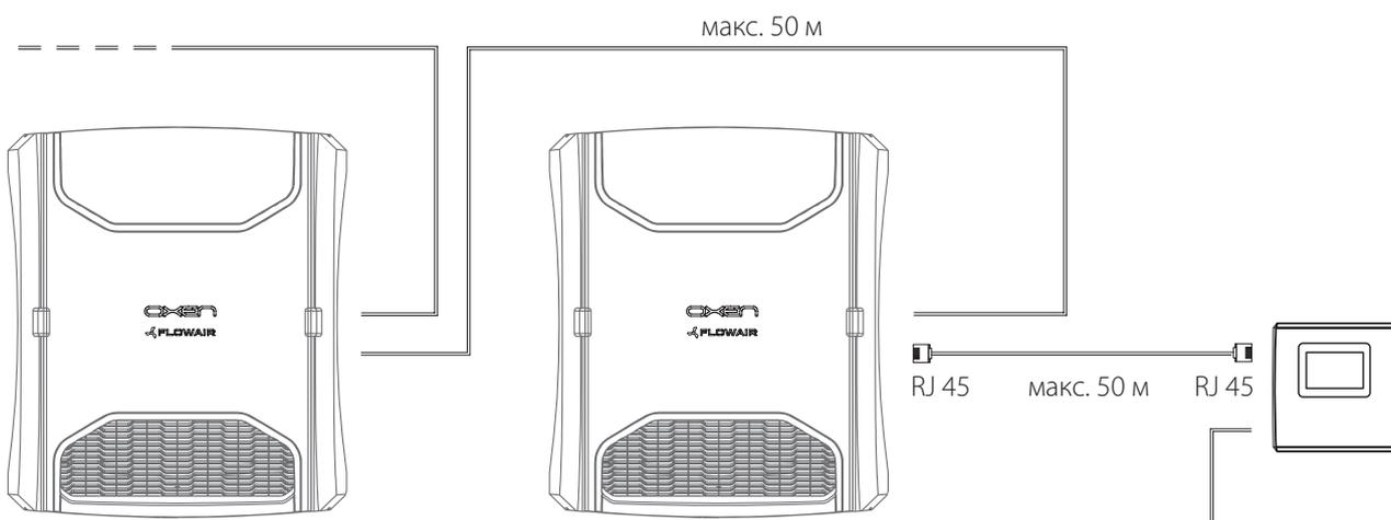
Установки с рекуперацией тепла OXeN можно управлять при помощи системы управления зданием BMS. В стандартном исполнении оборудование OXeN оснащено коммуникационным протоколом MODBUS RTU, который дает возможность записывать и считывать основные параметры работы.
